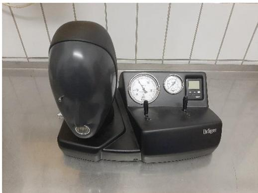
Der Atemschutzmasken Prüfkopf ist ein wichtiges Instrument um die Funktionsfähigkeit der Atemschutzmasken zu überprüfen und somit auch eine Lebensversicherung für unsere Atemschutzträger.
